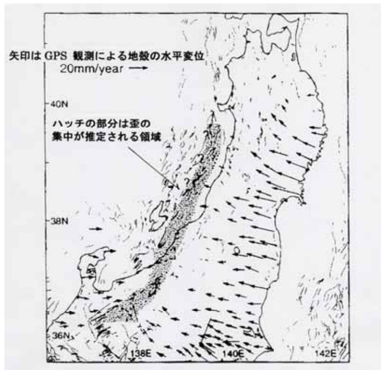
図11-3 GPS 観測による日本海東縁部における歪集中帯 (国土地理院資料)
